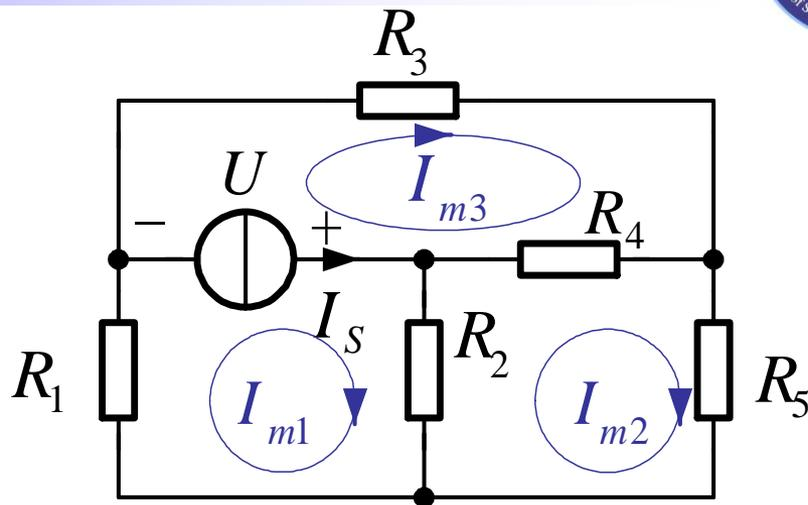
对电流源的两端电压，要作为变量列入方程中。
