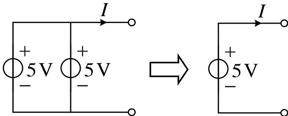
电压相同的电压源
