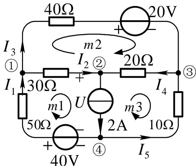
例2.6 列写图示含电流源电路的支路电流方程。
