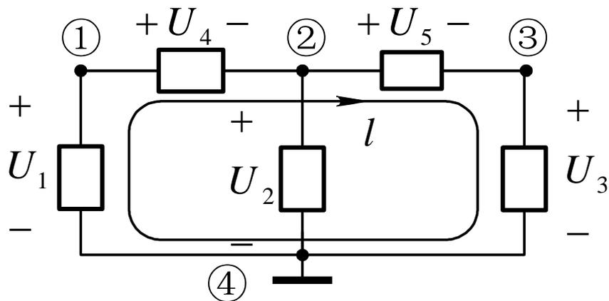
节点电压与支路电压关系:
