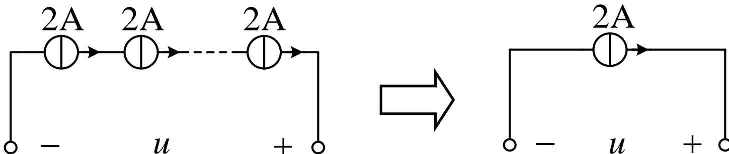
电流相同的电流源才能作方向一致的串联。
