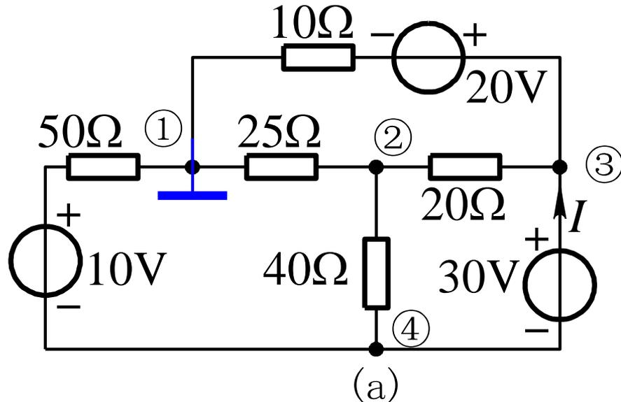
说明：若电路中存在纯电压源支路，则该支路的电流不能用支路电导与相关节点电压之积来表示。为解决这类问题，须对节点电压法进行修正，建立所谓的**改进节点电压法**。
