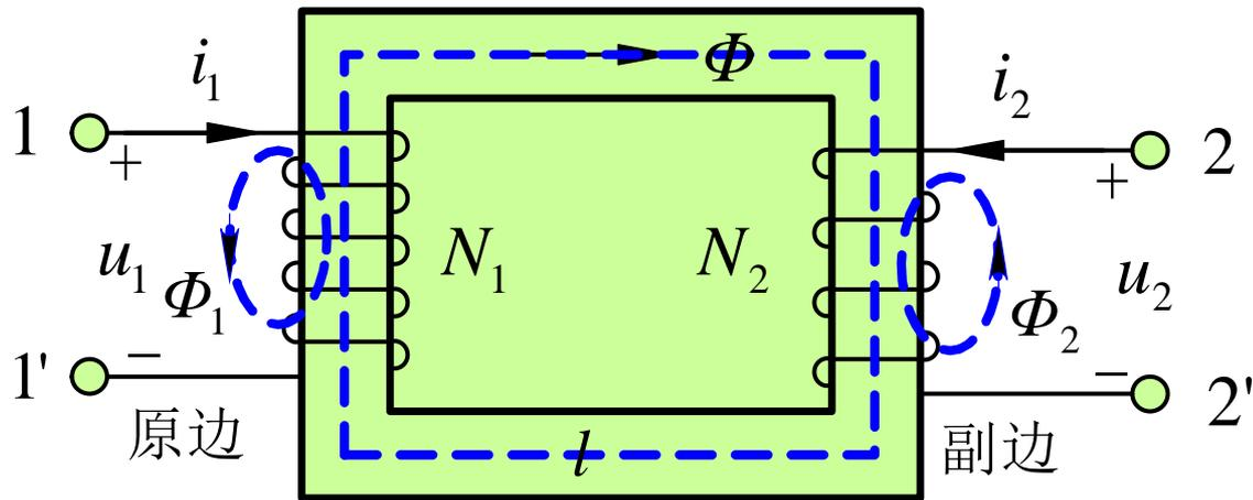
图5.22 变压器示意图
