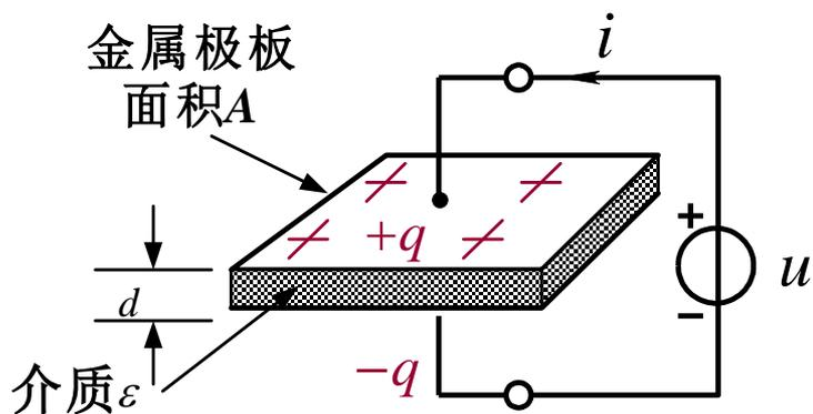
图5.2 电容的基本构成
