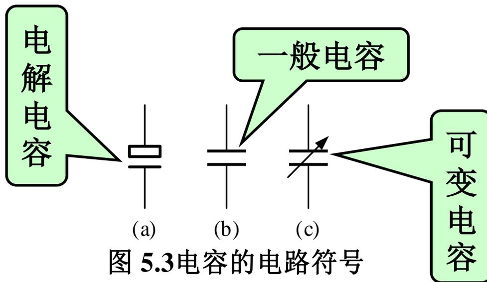
图 5.3 电容的电路符号
