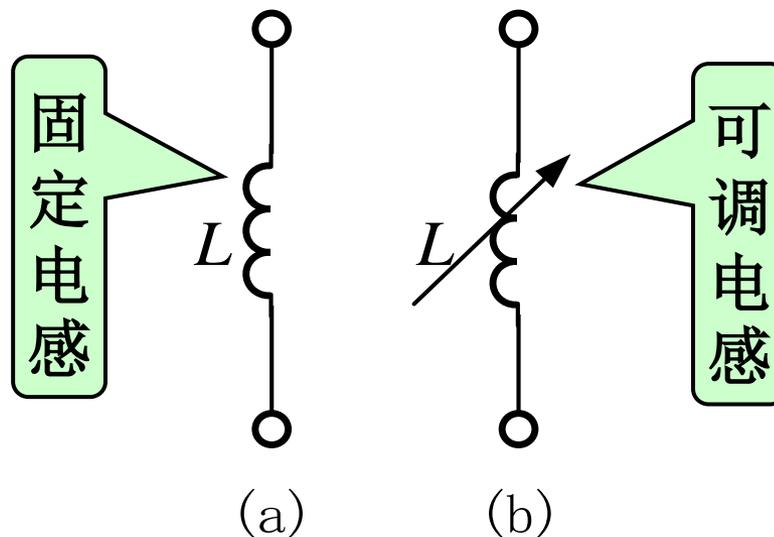
图5.10 电感线圈原理示意图
