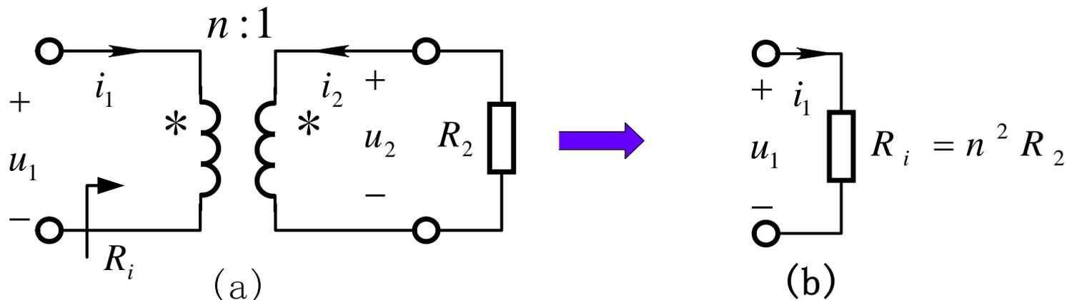
图 5.25 理想变压器的电阻变换
