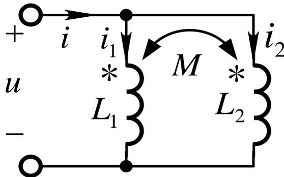
图5.19(a) 互感两同名端并联电路
