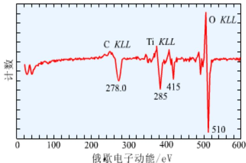
图10-15 金刚石表面的Ti薄膜的俄歇定性分析谱
