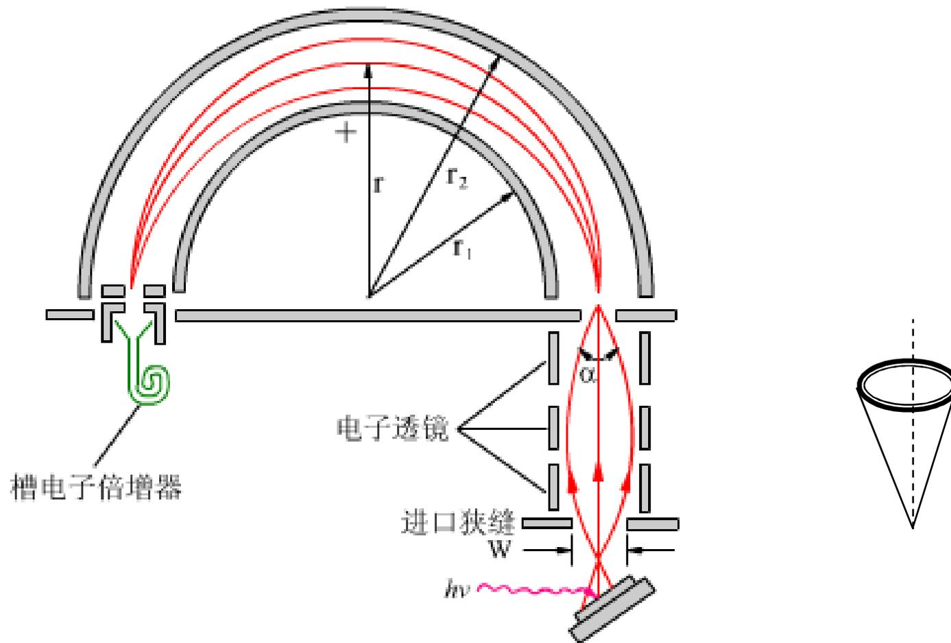
图 10-11 半球形电子能量分析器示意图
