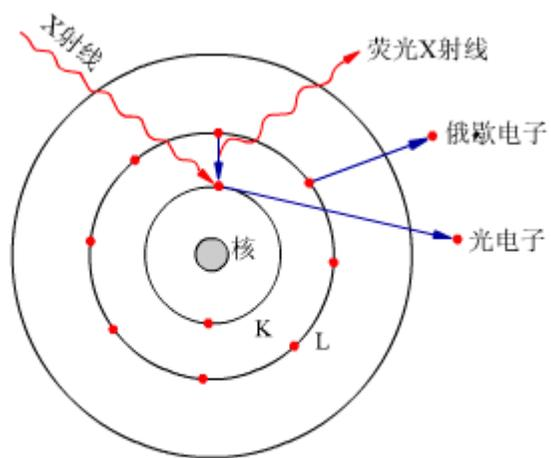
图10-1 荧光X射线及俄歇电子产生过程示意图
