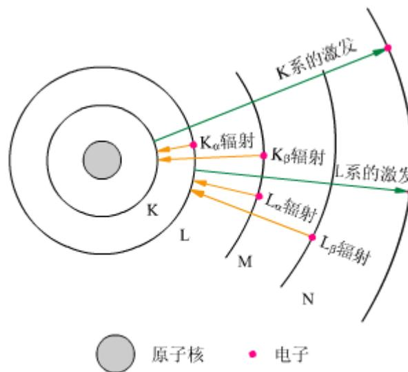
图10-2 产生K系和L系辐射示意图
