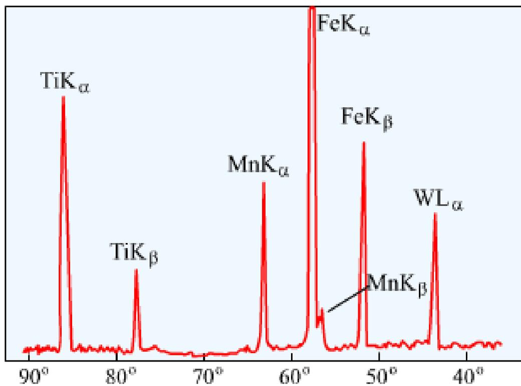
图 10-9 一种合金钢的荧光 X 射线谱
