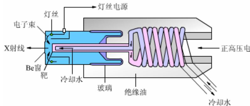
图10-4 端窗型X射线管结构示意图
