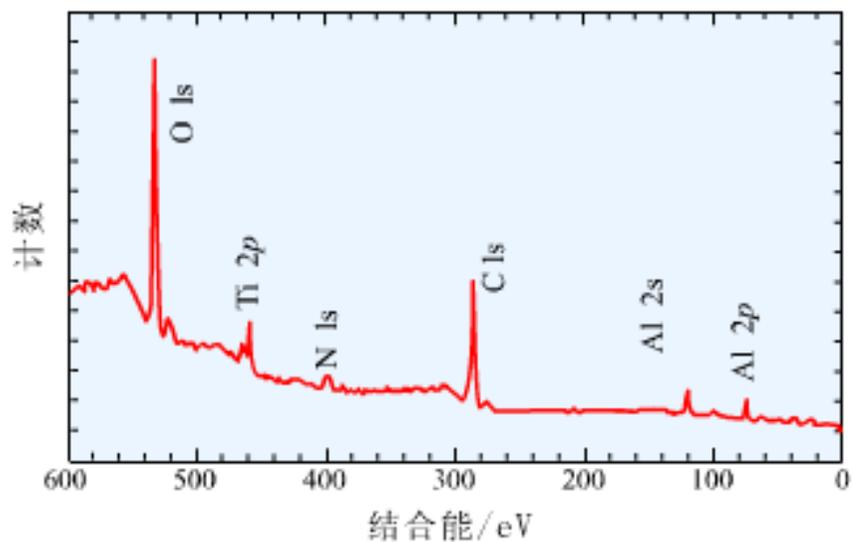
图10-12 高纯Al基片上沉积的 $Ti(CN)_x$ 薄膜的XPS谱图(激发源为 $MgK\alpha$ )
