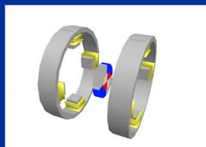
转子上需要有一片薄盘，盘上绕有轴向控制线圈，不必绕三组线圈以实现转子的控制，结构繁琐。
