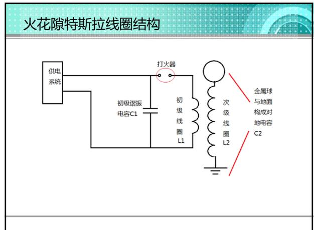
**特斯拉线圈原理——谐振**
