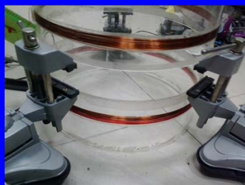
控制两线圈间距采用台钳来控制其距离。
