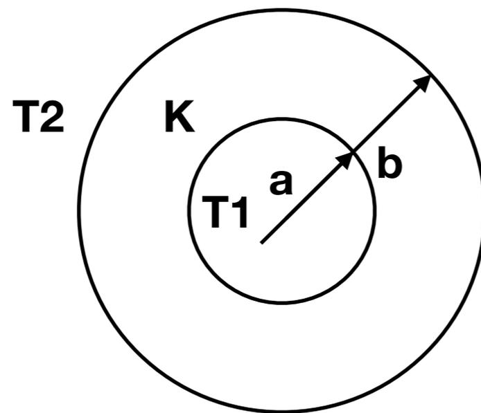
由于前面的分析，我们可知这个问题与静电场问题相似，因此我们先进行类比，我们熟悉的类似的静电学问题是同轴电缆问题：同轴电缆内外电势差为 $U$  ( $\phi_1 - \phi_2$ )，内半径为 $a$ ，外半径为 $b$ ，内部填充了一层同轴的电介质材料。既然热流矢量 $h$ 对应电场矢量 $E$ ，我们所要求的 $G$ 就应是长度为 $L$ 的同轴电缆的电场通量。
