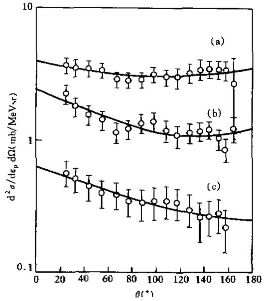
图 2 不锈钢(n, xp)核反应出射质子的角分布
