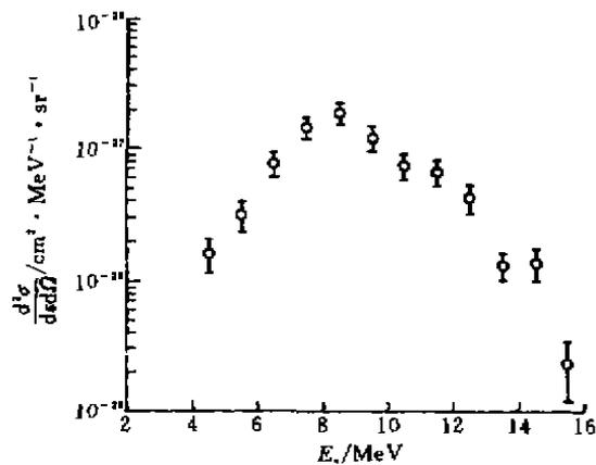
图 4  $^{60}\text{Ni}(n, \alpha)$  反应在  $88.3^\circ$  时的双微分截面
