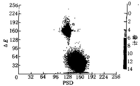
图 3 二维  $\Delta E$ -PSD 粒子分辨谱
