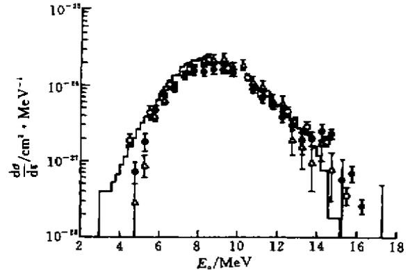
图6  $^{238}\text{Ni}(n, \alpha)$  反应的出射 $\alpha$ 粒子能谱
