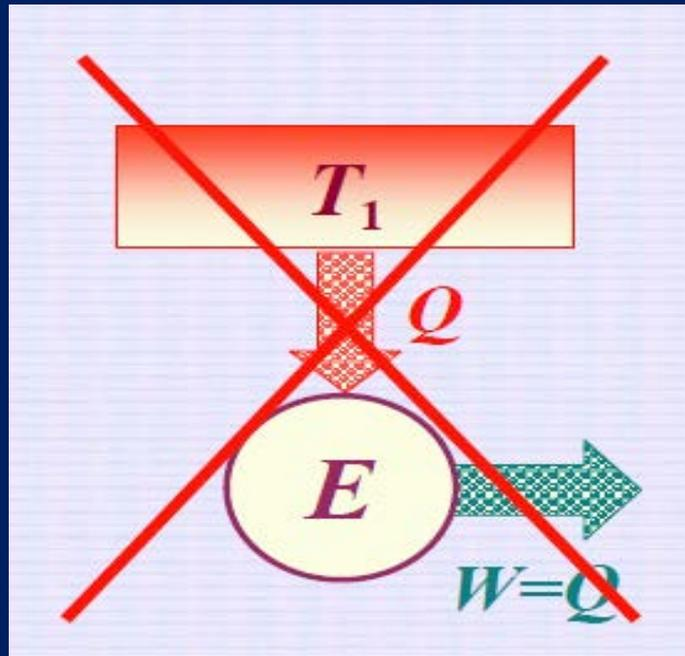
实际热机最少要有两个热源( $T_1, T_2$ ), 其效率 $\eta < 100\%$
