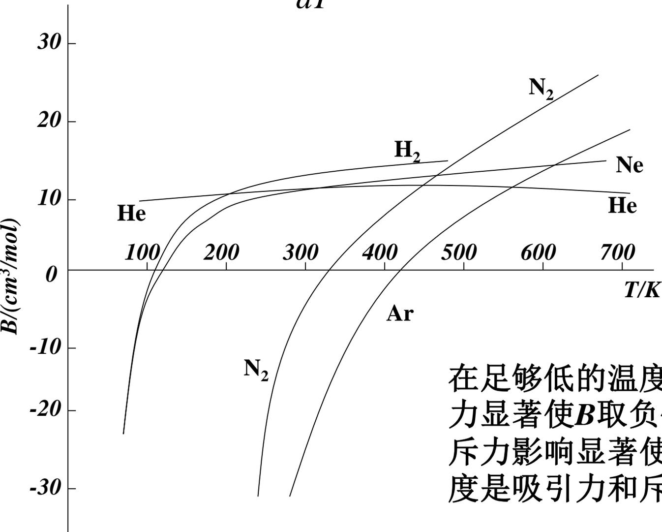
在足够低的温度下, 分子间吸引力显著使  $B$  取负值, 温度足够高时, 斥力影响显著使  $B$  取正值。反转温度是吸引力和斥力竞争的结果。
