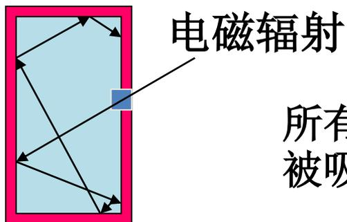
所有入射的电磁辐射经过多次反射，几乎都被吸收，不能反射——近似黑体
