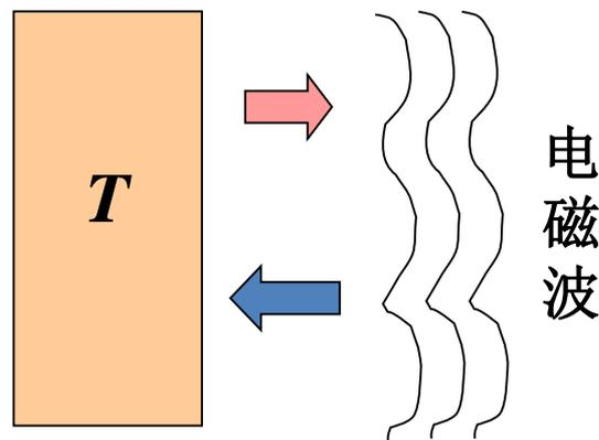
**平衡辐射：**若某物体在单位时间内向外辐射的能量恰好等于它所吸收的外来辐射能，则称为平衡辐射。它包含各种频率沿各个方向传播的电磁波。
