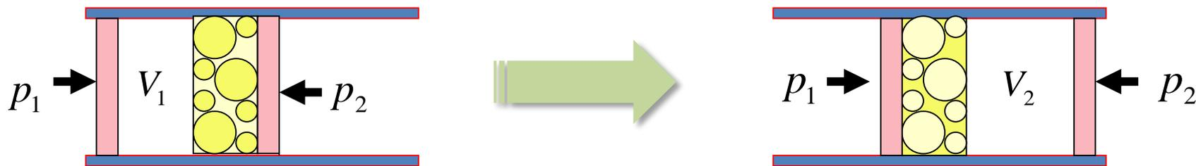
该装置用绝热材料包着，管子中间有一个多孔塞（也叫节流阀）。两边维持着较高的压强  $p_1$  和  $p_2$ ，于是气体从高压的一边经过多孔塞缓慢地流到低压的一边，并达到定常状态，这就是**节流过程**。实验表明，节流过程前后，一般情况下气温发生**变化**。
