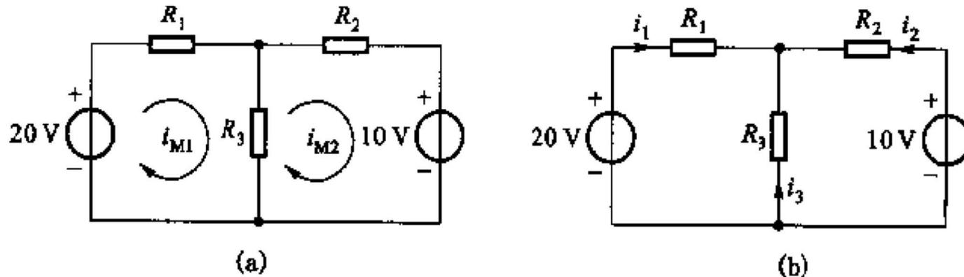
解 该电路有2个网孔，假设每一个网孔内网孔电流为 $i_{M1}$ 和 $i_{M2}$ ，并假定它们都是顺时针方向。
