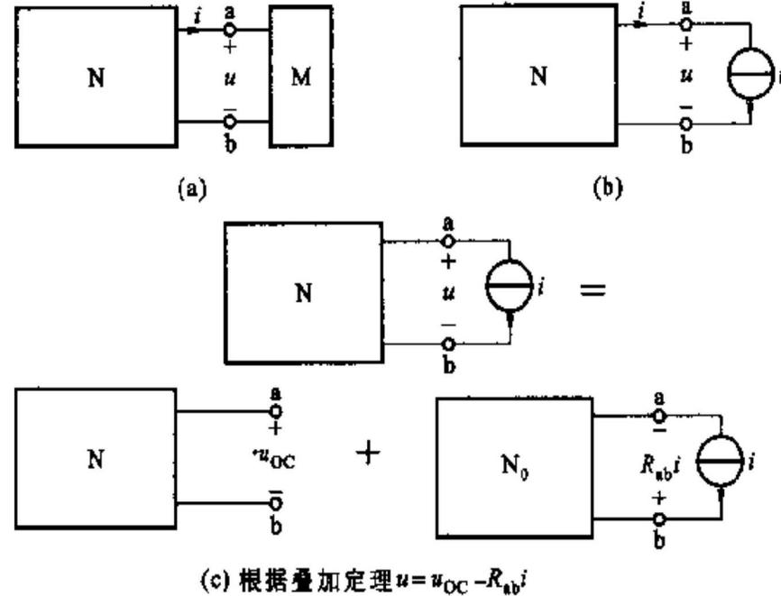
$$u = (\text{电流源 } i \text{ 产生的电压}) + (\text{N 中所有独立源产生的电压})$$
