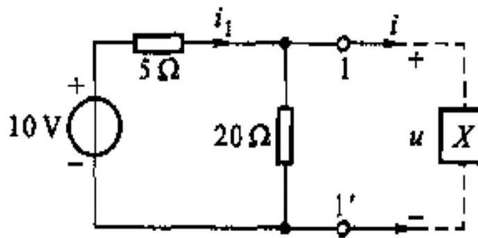
外施电压源求电流法
