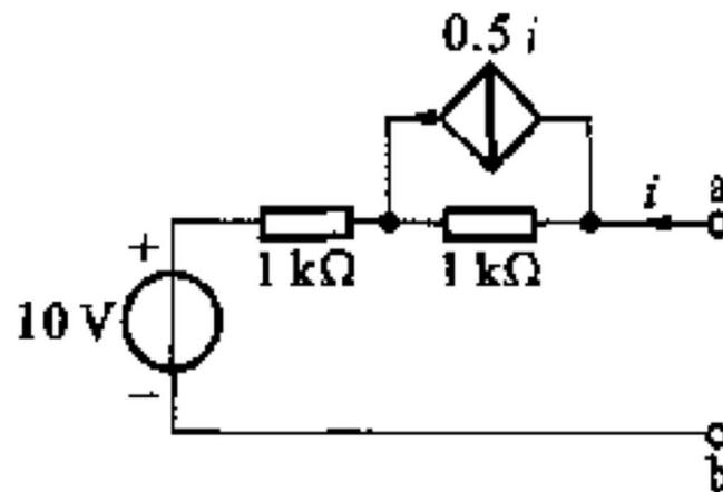
为了求等效电阻，可先求短路电流。把电路ab端短路，设短路电流 $i_{sc}$ 的方向如后面图中所示，则受控源电流为 $0.5i_{sc}$ ，且其方向应与上图方向相反。
