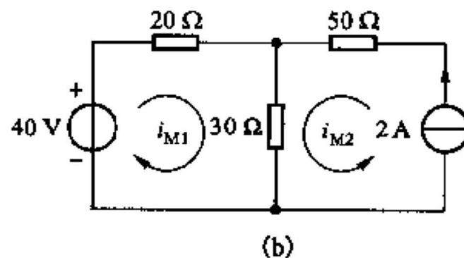
解 电路含有电流源，其支路电流即为电流源的电流值，因此，流经 $50\Omega$ 电阻的电流等于 $2A$ ， $i_{M2}$  按电流源的方向， $i_{M2}=2A$ 。只要列出网孔1的方程即可。
