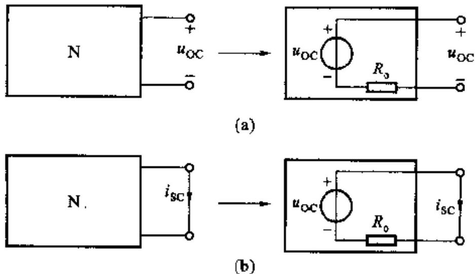
解 已知一个含源单口网络可等效为一个电压源  $u_{oc}$  与电阻  $R_o$  的串联电路。因此，原网络的短路电流  $i_{sc}$  应等于这个等效电路的短路电流，故得
