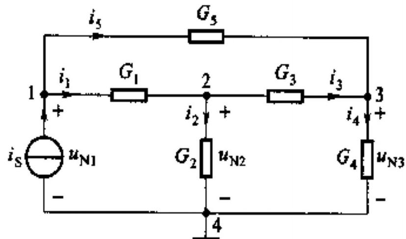
$$\left. \begin{aligned} (G_1 + G_5)u_{N1} - G_1 u_{N2} - G_5 u_{N3} &= i_S \\ -G_1 u_{N1} + (G_1 + G_2 + G_3)u_{N2} - G_3 u_{N3} &= 0 \\ -G_5 u_{N1} - G_3 u_{N2} + (G_3 + G_4 + G_5)u_{N3} &= 0 \end{aligned} \right\}$$
