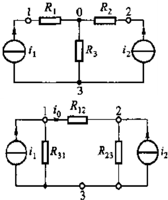
$$R_{mn} = \frac{\text{电阻两两乘积之和}}{\text{接在与 } R_{mn} \text{ 相对端钮的电阻}}$$
