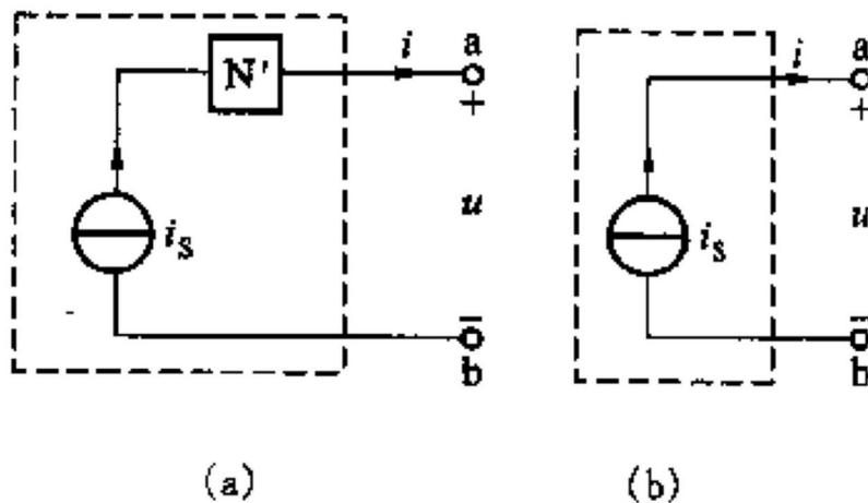
N'不影响端口电流的大小，端口电流总等于电流源的电流。N'为**多余元件**。
