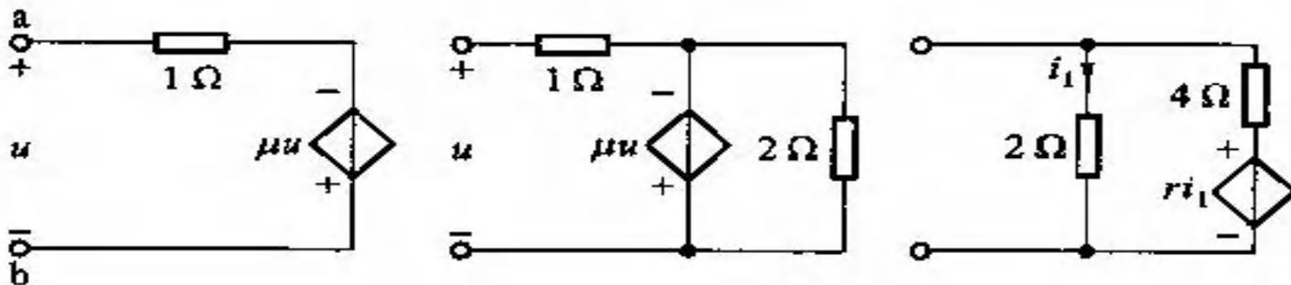
解 只含电阻和受控源单口网络，其端口电压与端口电流的比值称为输入电阻。在计算网络电阻时，可直接计算此比值。外接一个电压  $u$ ，则：
