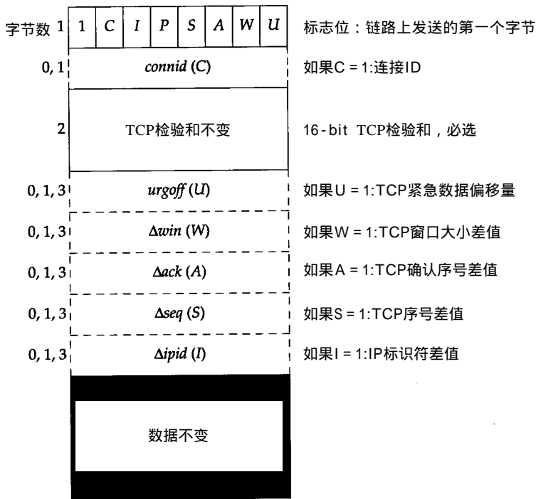
图29-34 压缩后的IP/TCP首部格式
