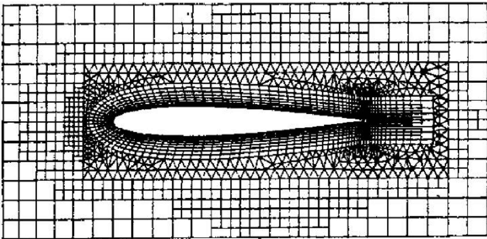
图 2 73 结构化与非结构化的混合网格
