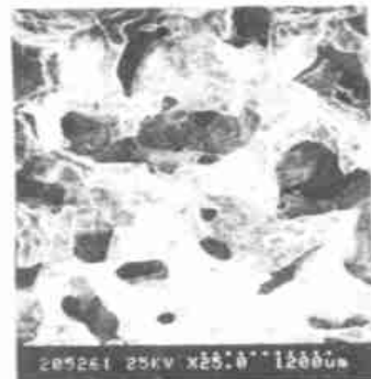
图2 泡沫铝微观结构SEM照片
