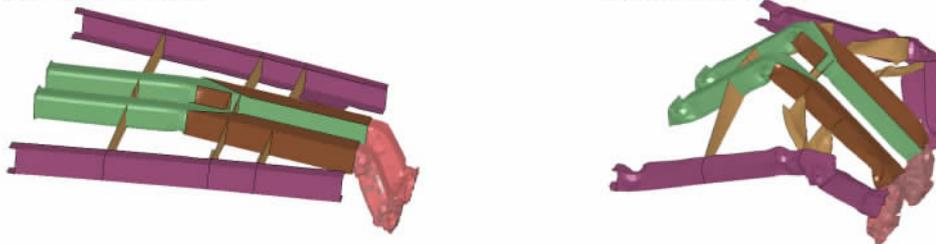
图9 方案4的牵引梁和吸能管的变形情况
