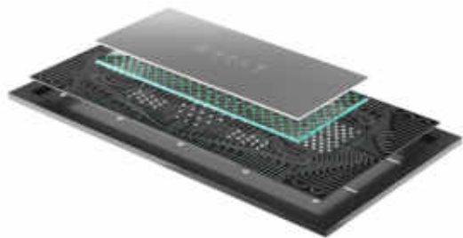
图:祖冲之三号芯片示意图。105个可读取比特和182个耦合比特集成在同一个芯片上执行量子随机线路采样任务
