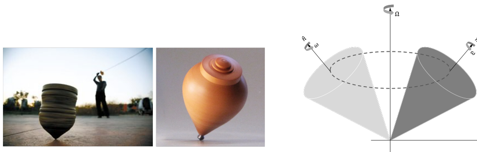
图 14. 陀螺是一种典型的做定点转动的刚体
