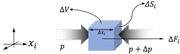
图 6. 一般力作用下的流体静力平衡
