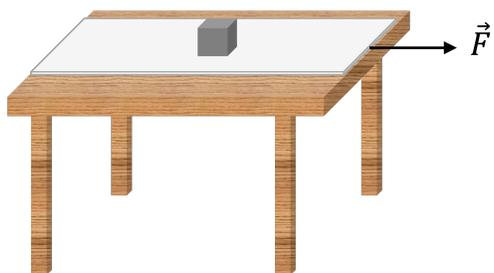
**【例 7】** 一个质量为  $M$  的薄木板静置在水平桌面上，木板与桌面大小相同且一端与桌边对齐。木板中心放着一个质量为  $m$  的小木块。现在将一个恒定的水平力  $F$  作用在木板上，要将木板从木块下抽出来，又要是木块不掉到地上。假定各个接触面的摩擦系数均为  $\mu$ ，求  $F$  至少多大。
