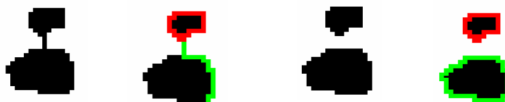
图 17 细连接线所造成轮廓跟踪时的错误及经过腐蚀运算后的轮廓跟踪
