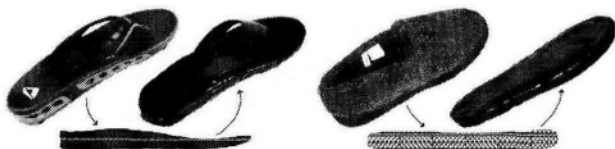
图 20 多元材料组合打印实例 [50]
