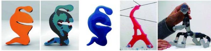
首先通过材料的薄厚分布使物体的不同部位拥有不同程度的形变能力, 再利用大头针固定, 细线牵引或手动进行驱动
