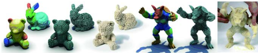
给定一个虚拟物体各个部位的弹性材料属性(如图中的蓝色表示柔软,红色表示坚硬),系统自动通过中观尺度的结构设计来逼近预期的形变效果,并且只利用单种材料制造出来
