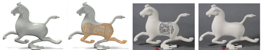
图16 使用“蒙皮-刚架”的3D打印技术。生成内部网状的支撑结构在保证物理及力学性质(强度和稳定性)的情况下,使用最少的打印材料<sup>[22]</sup>
