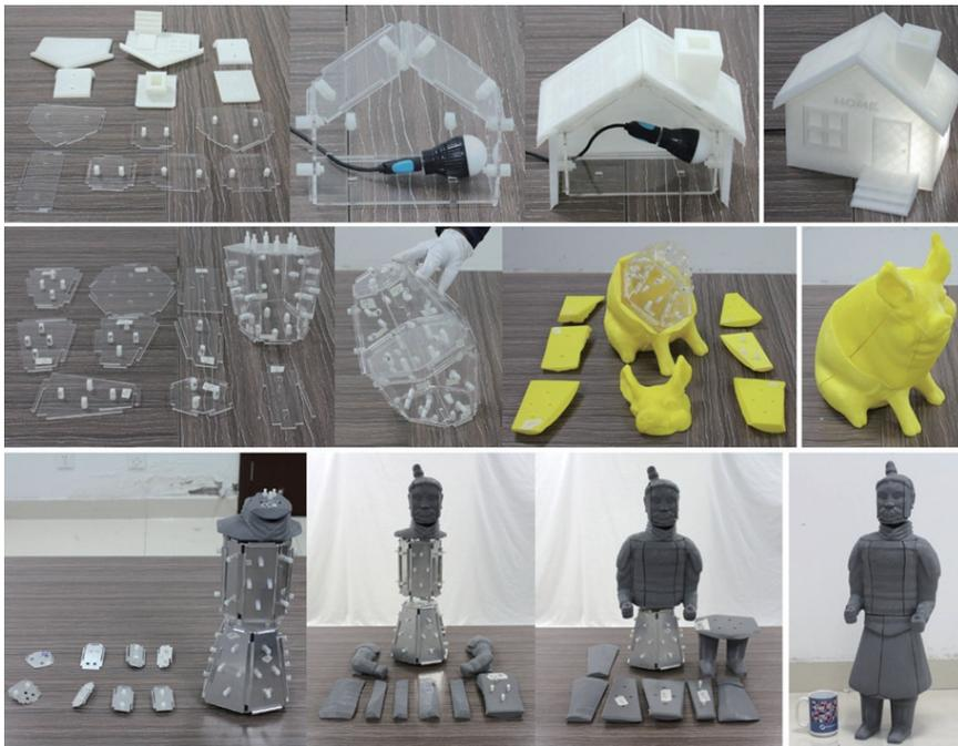
图 17 结合 3D 打印与激光切割的制造技术。内部板块状部件使用激光切割制造，外部部件使用 3D 打印制造，从而节省打印材料的使用，大大缩短了制造速度<sup>[23]</sup>
