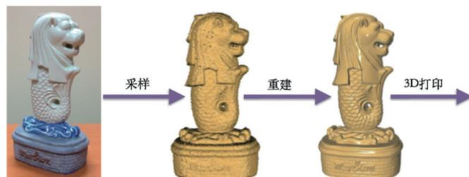
图7 对实物扫描得到点云,通过重建方法得到三维模型,最终通过三维打印得到实物<sup>[12]</sup>
