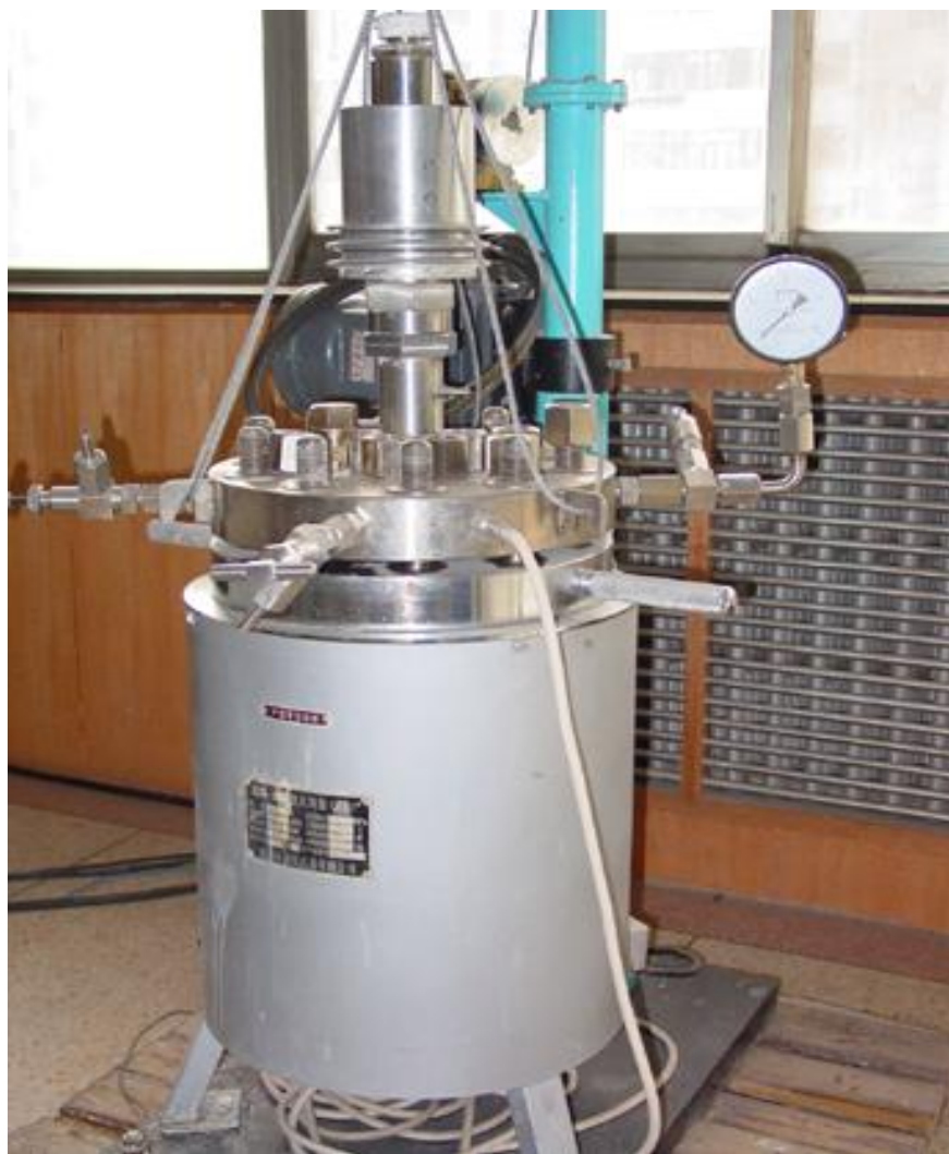
商品化的带搅拌高压高温反应釜装置图
