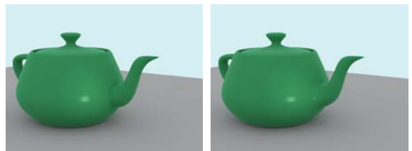
(c) Gap-free T-Spline model. (d) Gap-free C^2 fillet.
