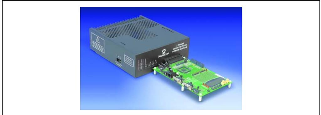
dsPICDEM MC1L 三相低电压功率模块经过优化，适用于要求直流母线电压低于 50V 而输出功率高达 400W 的三相电机应用。该低电压模块旨在为 BLDC 和 PMAC 电机供电。
