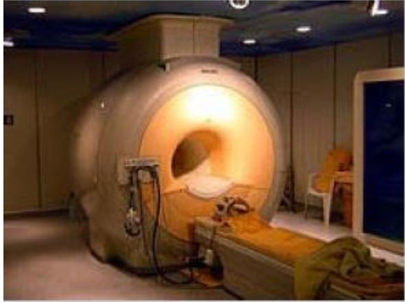
液氦用于冷却现代核磁共振成像扫描系统中的超导磁铁
