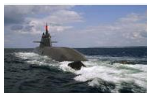
采用氢燃料电池的德国海军212A型 潜艇
