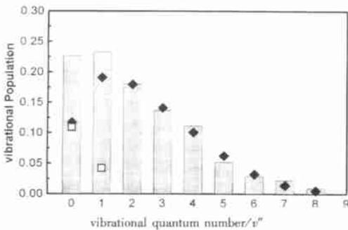
图 2 210.27 nm 下产物 CS(<sup>1</sup>X<sup>1</sup>) 的相对振动布居柱状图为实验测量结果, 通过(1)式拟合得到的对应于 S(<sup>3</sup>P<sub>1</sub>) 通道的 CS 振动布居, 从总的布居中扣除 S(<sup>3</sup>P<sub>1</sub>) 通道的贡献而得到的 S(<sup>1</sup>B<sub>2</sub>) 通道的布居.
