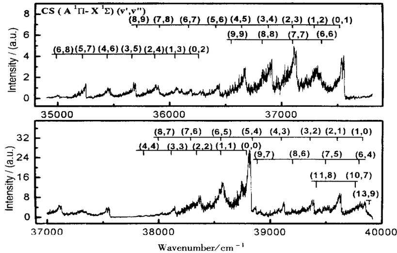
图 1 210.27 nm 下光解碎片 CS(<sup>1</sup>X<sup>1</sup>) 在 286.5 ~ 250.5 nm A<sup>1</sup> X<sup>1</sup> + 跃迁的振动分辨 LIF 激发谱及其标识 (v', v'') 为 CS <sup>1</sup>X<sup>1</sup> + 态 v' 振动能级到 A<sup>1</sup> 态 v'' 振动能级的跃迁 (谱峰强度已扣除探测光强变化的影响).
