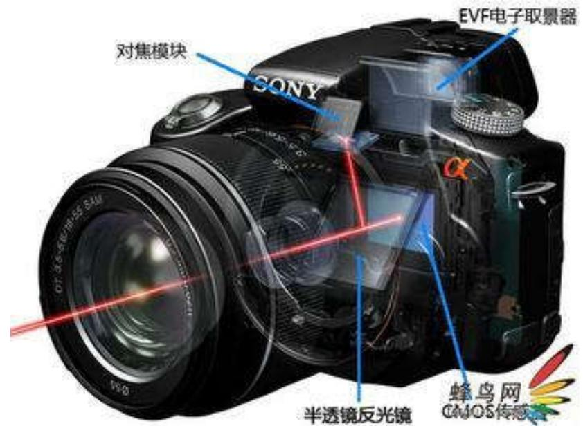
单电相机（索尼称微单），是指可换镜头但无反光板的相机，由于没有反光板和五棱镜，因此尺寸更小巧。反光镜将约三成的光线反射到顶部的自动对焦系统，而将七成光线投射到成像元件上，所以曝光度比其他机型要低1/2EV左右。
