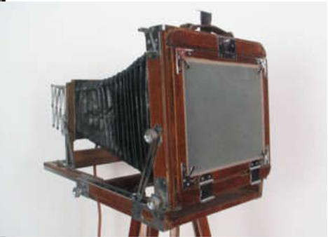
特点：无反光镜，直接取景对焦。
