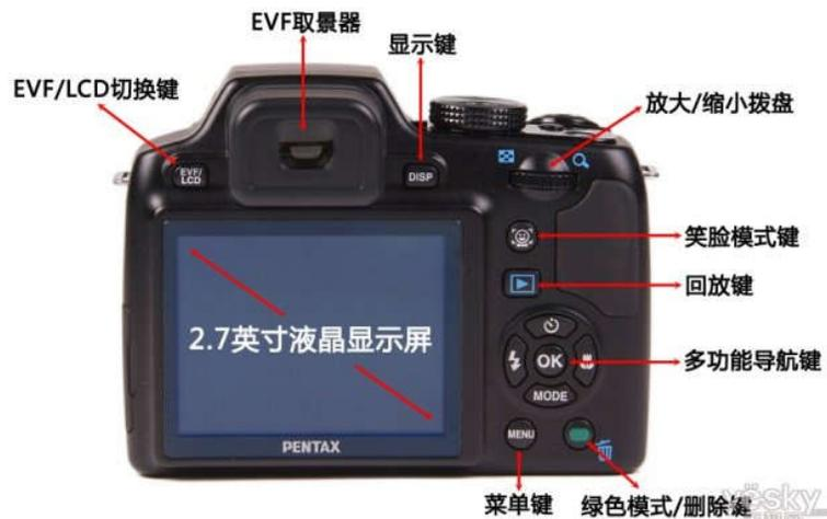
电子取景器 (EVF) 取代光学取景器 (OVF)，逐渐取消五棱镜和反光板，与传统的单反相距甚远。
