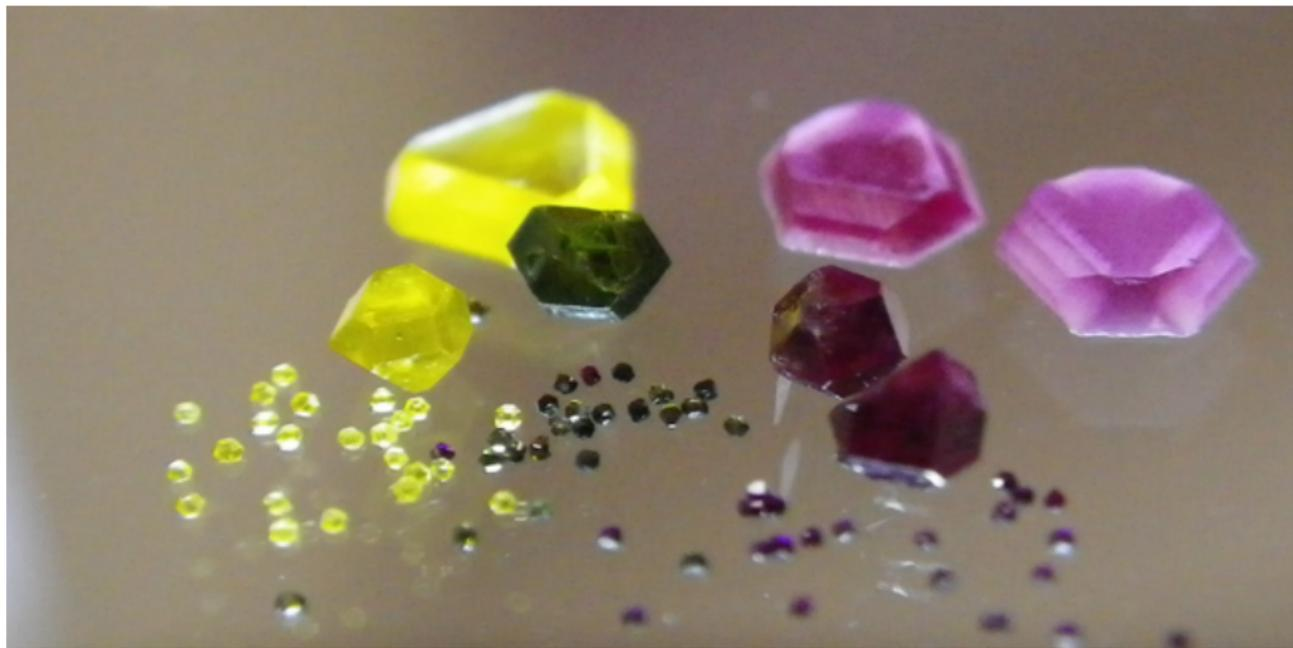
不同类型、浓度的缺陷导致晶体（钻石）颜色不同
