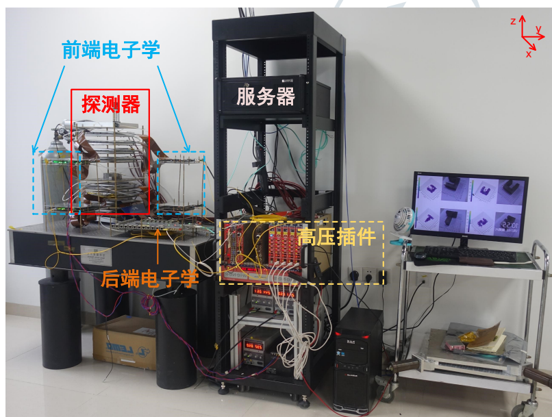
图 5.2 散射成像实验样机
