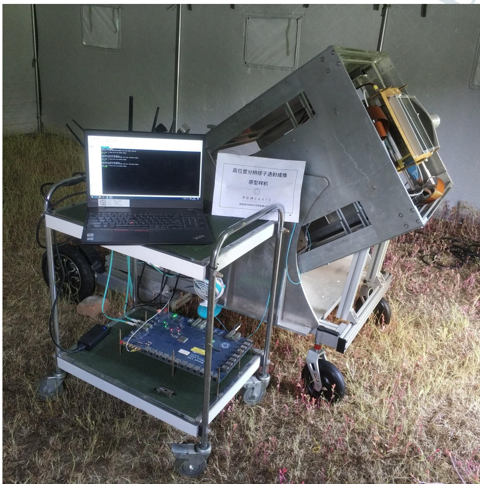
图 5.3 透射成像实验样机
