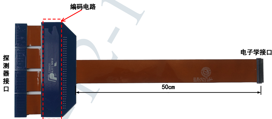
图 3.8 基于哈密顿回路的编码读出板实物图
