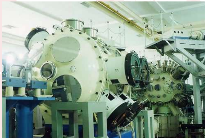
神光II装置激光靶场系统
