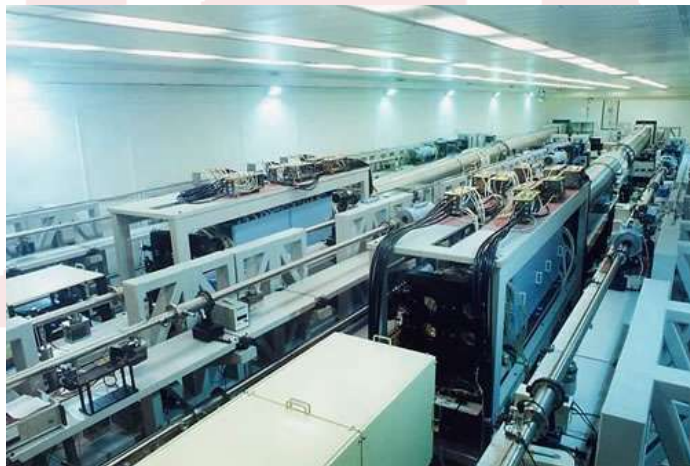
神光II装置激光主放大系统
