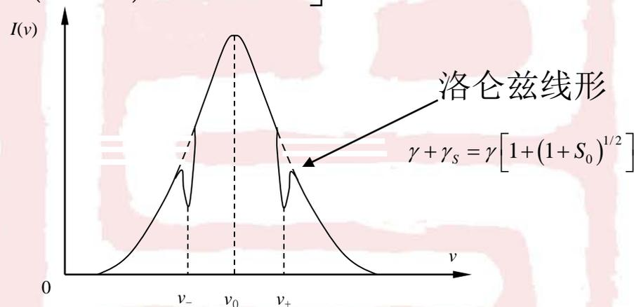
用一束强饱和吸收激光和一束弱探测激光测量到贝立特洞
