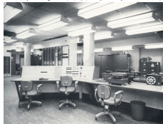
TX-0, MIT林肯实验室, 1956, 它将键盘、打印机、磁带阅读机和打孔机集成在一起, 操作员可以通过键盘编程, 生成印好的磁带后直接输入机器; 配有一台可编程显示器。
