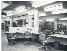
TX-0, MIT林肯实验室, 1956, 它将键盘、打印机、磁带阅读机和打孔机集成在一起, 操作员可以通过键盘编程, 生成印好的磁带后直接输入机器; 配有一台程显示器。
