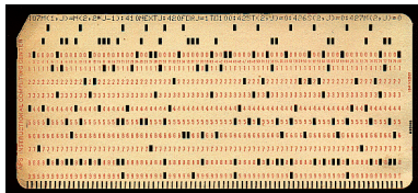
穿孔卡片(punched card)：在硬纸板上打孔以记录信息的工具。（图：IBM12行80列穿孔卡）
