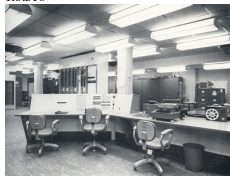
TX-0, MIT林肯实验室, 1956, 它将键盘、打印机、磁带阅读机和打孔机集成在一起, 操作员可以通过键盘编程, 生成印好的磁带后直接输入机器; 配有一台可编程序显示器。
