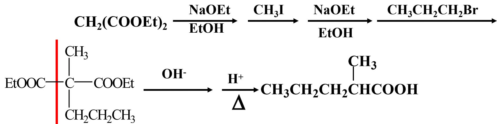
例5: 选用合适的原料制备下列结构的化合物。
