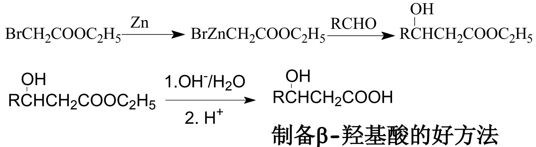
此反应类似于格氏试剂对羰基的加成，但有机锌试剂活性较差，在反应条件下不与酯羰基加成，故可以得到 $\beta$ -羟基酸酯。
