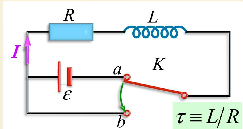
可见电阻上产生的焦耳热来源于线圈中的磁能，电感线圈是一个储能元件。
