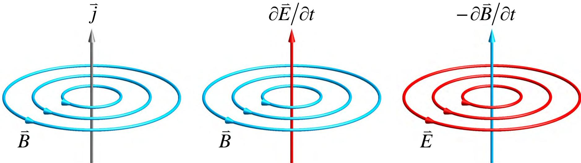
**【例】** 研究平行板电容器在充放电过程中，磁场与传导电流、位移电流的关系。设极板半径为  $a$ ，极板间距为  $d \ll a$ ，并设电荷随时间缓慢变化。
