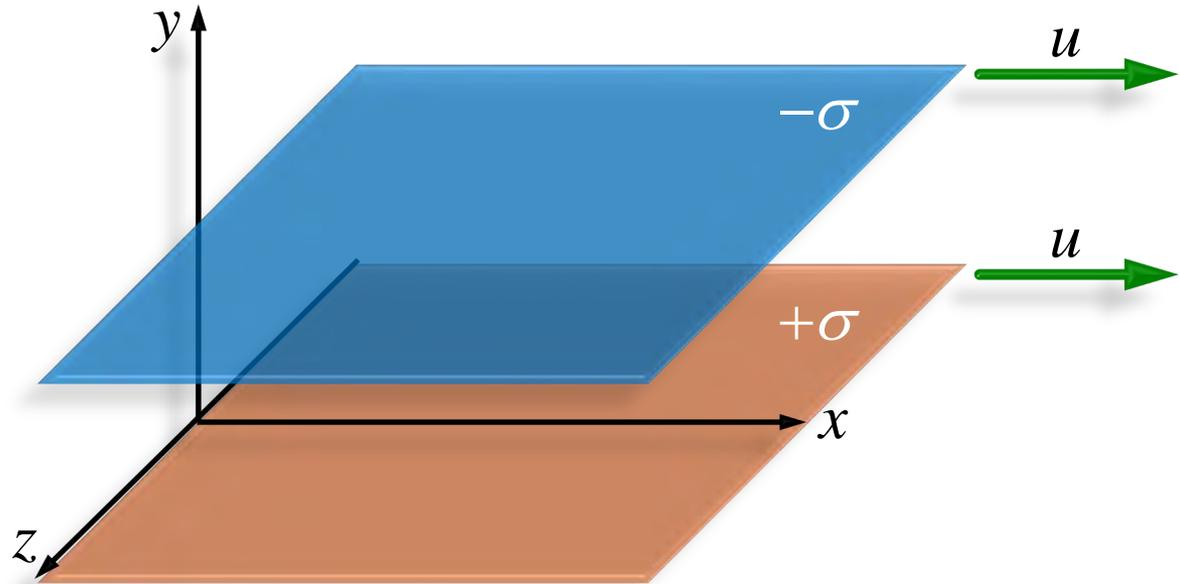
【注2】 设  $\sigma_0$  为正极板的固有面电荷密度，则在  $K$  和  $K'$  系中相应的面密度分别为  $\sigma = \gamma\sigma_0$  和  $\sigma' = \gamma'\sigma_0$ ，而由于
