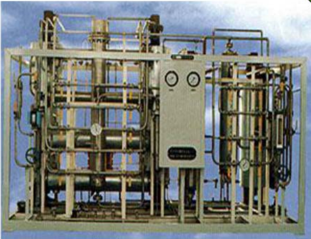
氢气纯化装置
