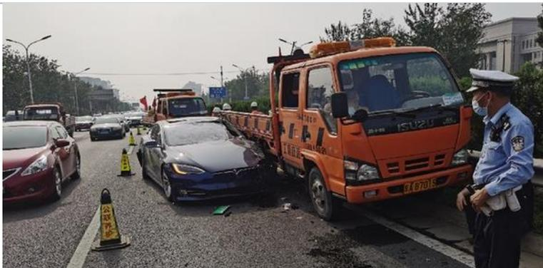
2020年7月29日，北京南四环特斯拉Model S 自动驾驶交通事故，速度80km/h，前方的道路养护货车正在作业，特斯拉发现前方车辆后车辆自动向右并线避让，然而在避让到另外一个车道时，特斯拉却突然向左加速撞到了货车右轮处
