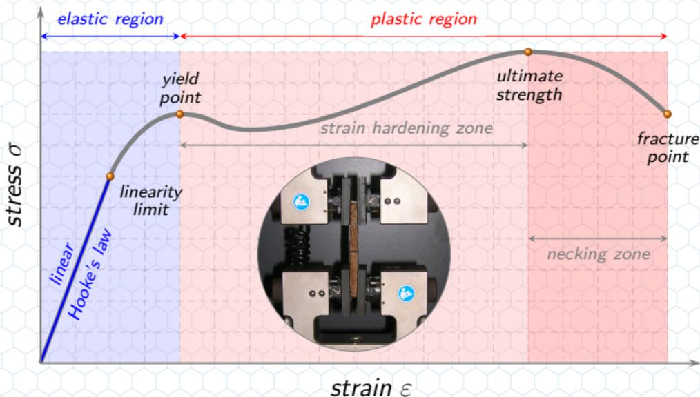
图—拉伸测试 (tensile test) 中典型的应力—应变曲线。<sup>1</sup>
