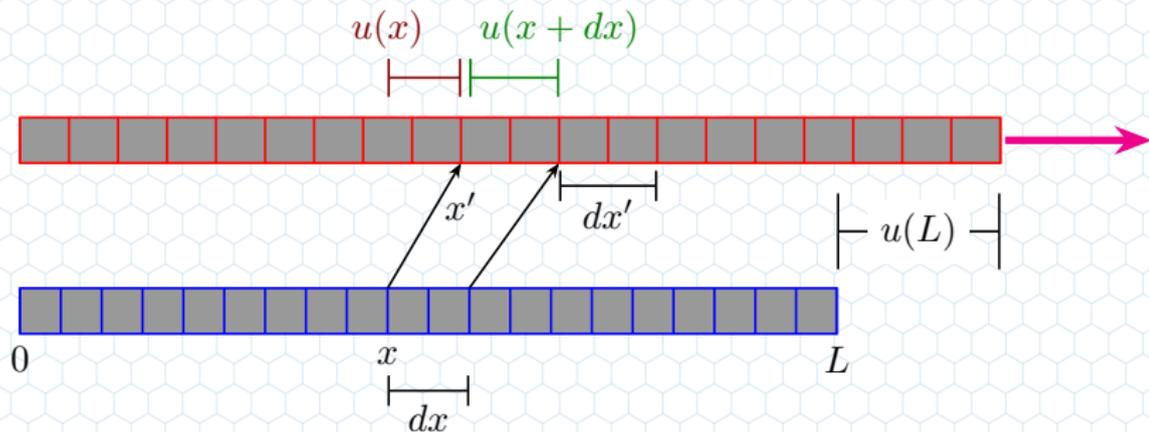
图 - 一根一维棒形变前后示意图。
