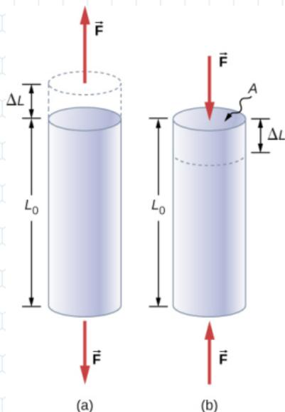
图 - 受到拉伸 (左) 和压缩 (右) 形变的物体。
