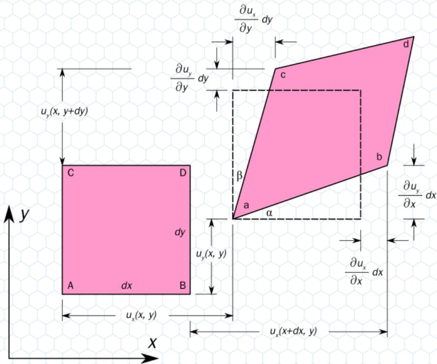
图一 二维位移场示意图。<sup>3</sup>
