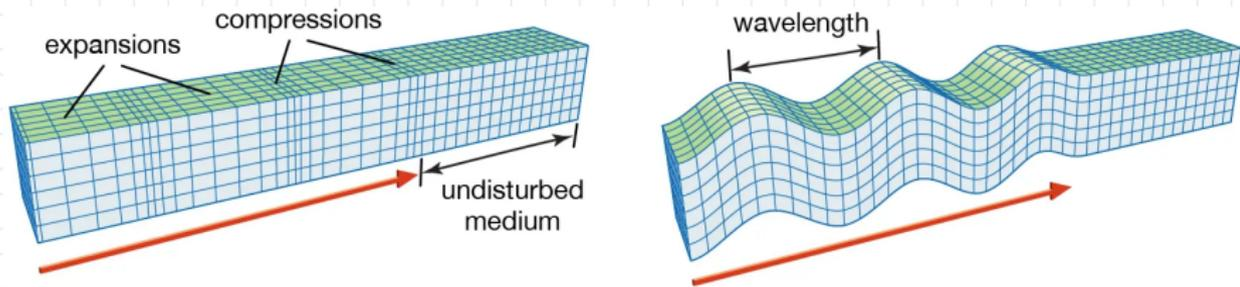
图 - 晶体的连续介质近似：弹性波波长远大于晶格间距 ( $\sim 10 \text{ \AA}$ )。
