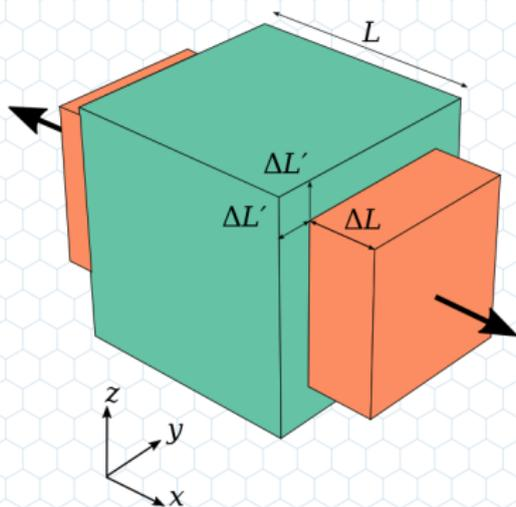
图 - 立方体受到  $x$  方向的拉伸时，其  $yz$  平面也同时发生形变，图片来自 wiki。<sup>12</sup>
