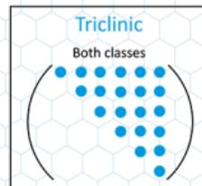
图 - 各种对称性下的弹性模量张量矩阵元分布。<sup>16</sup>
