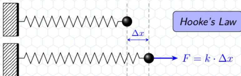
图 - 谐振子模型示意图。
