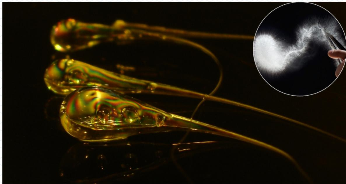
图 - 鲁珀特之泪 (*Prince Rupert's drop*)<sup>5</sup>: 将熔融玻璃滴入水中得到的“蝌蚪”状的玻璃泪珠, 头部存在大量应力, 特别坚硬 (真的可以挡子弹), 但是只要一捏尾巴就会爆掉。图中彩色条纹是通过光学的方法来显示应力的分布。<sup>6</sup>
