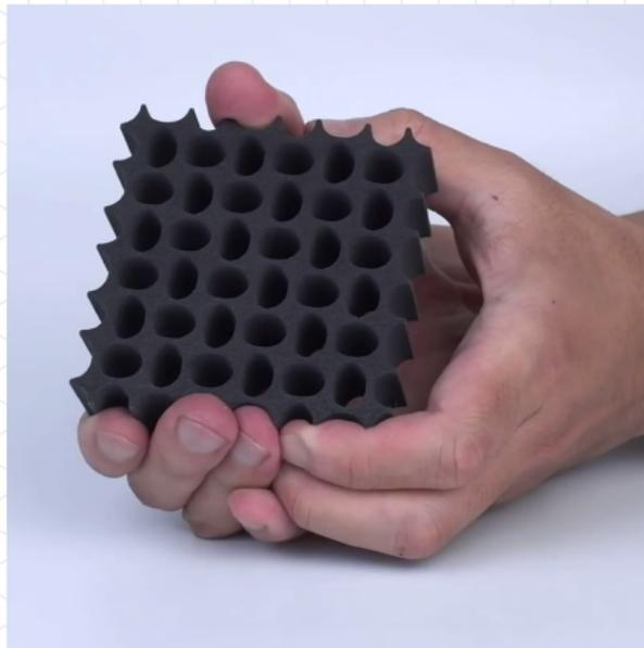
图 - 拉涨材料或结构是一种具有负泊松比 (Negative Poisson Ratio, NPR) 的材料或结构。<sup>14</sup>
