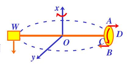
回转仪的回转速度应足够快,否则无法阻止倾倒发生。
