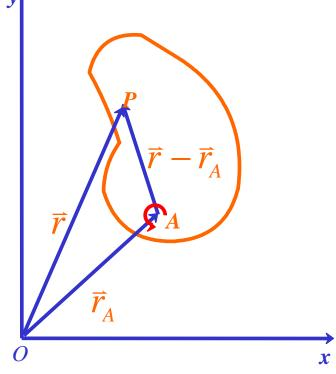
瞬时转动中心: 任一时刻,刚体(内)存在一点O',其速度  $\bar{v}_{O'} = 0$ 。整个刚体绕过O'点垂直于剖面的轴作纯转动。
