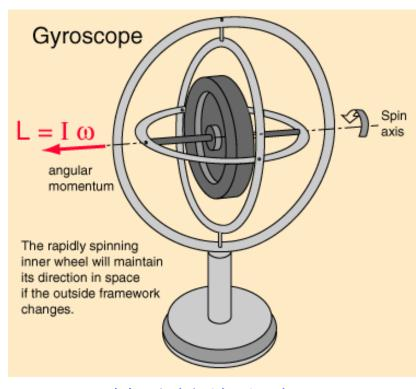
陀螺仪不受外力矩时角动量守恒,因而转动轴线方向 不变。用于方向导航的基本原理。
