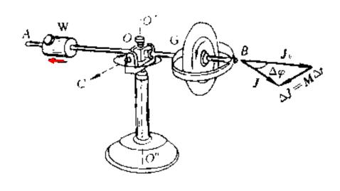
重力矩  $\overline{M}$  引起角动量  $\overline{J}_0$ 沿  $\overline{M}$  方向的变化。在  $\Delta t \to 0$  时间内有  $\Delta J = J_0 \cdot \Delta \varphi$
