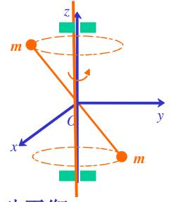
x、y轴受力矩作用。轴承提供约束反力。动平衡。
