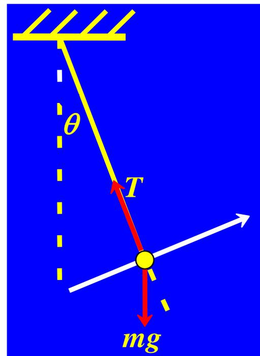
谐振方程的两个特解是  $\cos \omega_0 t$  和  $\sin \omega_0 t$  。二阶常微分方程的通解是两个特解的线性组合
