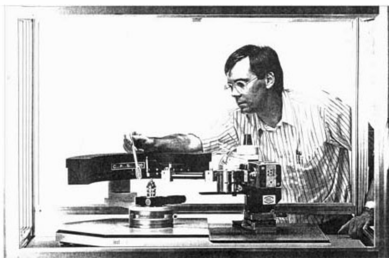
图 5-20 CPS-120 多晶体衍射仪
