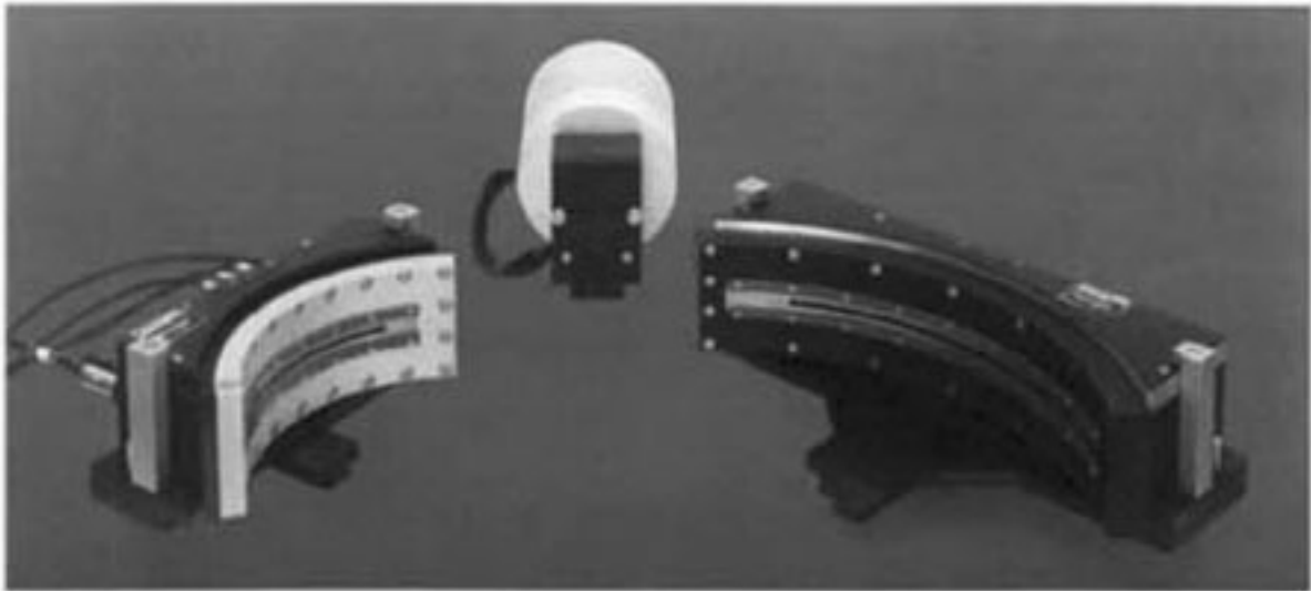
图 5-18 Stoe 公司生产的三种位敏探测器
