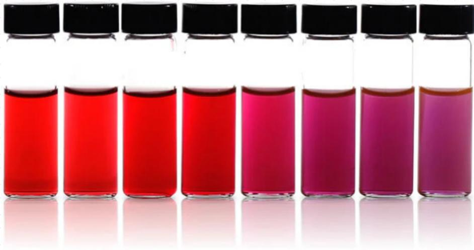
图 - 从左往右: 5 nm-10 nm 的金纳米颗粒悬浊液。<sup>3</sup>
